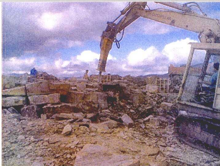
Fig. 22 Arranque de los planchones mediante una retroexcavadora de cadenas provista de un martillo picador. "Cantera Lastraspareira" (156018).
