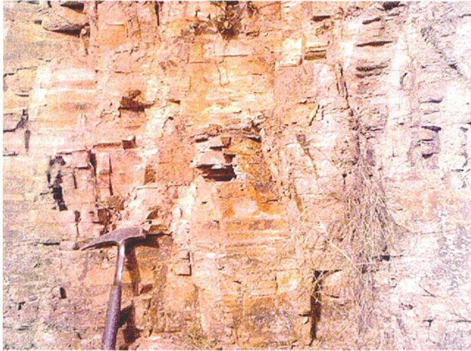
Fig. 27 Aspecto de los materiales correspondientes a las Cuarcitas de Cándana inferior y que se han explotado para áridos naturales en la "Explotación Pacios" (124004). Se trata de unas cuarcitas arenosas muy alteradas (R2), en niveles de espesor centimétrico, con una laminación paralela.
