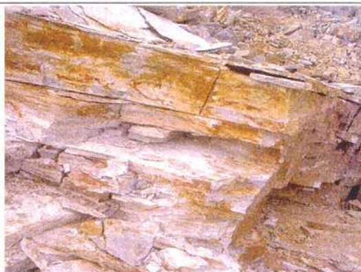
Fig. 10 Aspecto de las cuarcitas arenosas pertenecientes a la Cuarcita de Cándana Superior en la explotación "Cantera Marisol" (24003)
