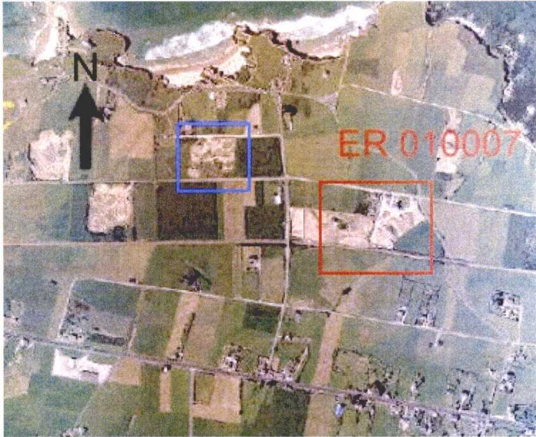
Fig. 16 Fotografía aérea de la cantera "Pizarras y Cuarcitas Manuel"(10007). En rojo se muestra el frente de explotación actualmente inactivo (cantera Devesa) y en azul el frente activo (cantera Manuel).
